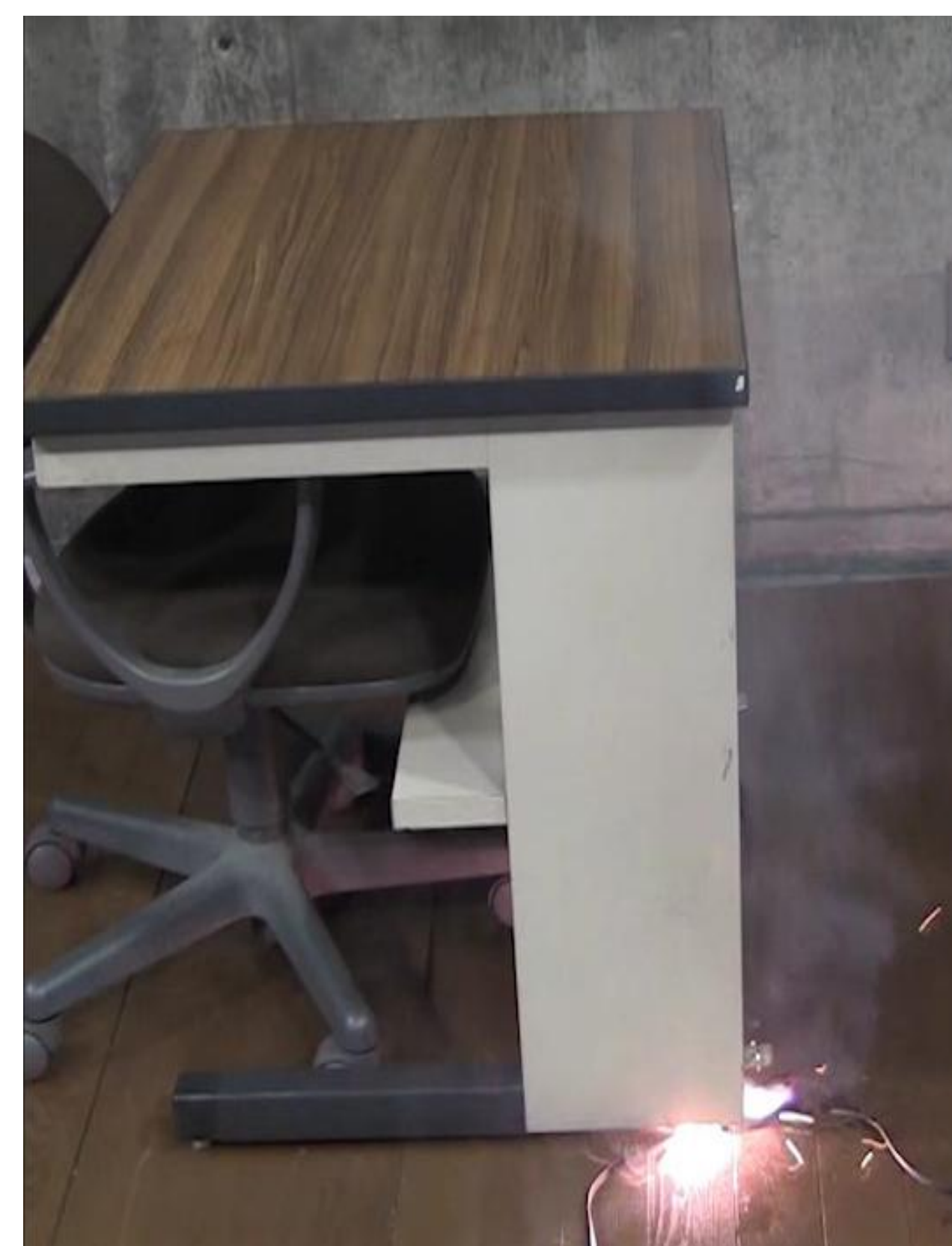
【NITEの再現実験】机の脚で踏みつけていたコードから発火
