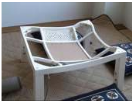
ダクト口をファンヒーターに近づけ過ぎたため(右)に変形したこたつ
