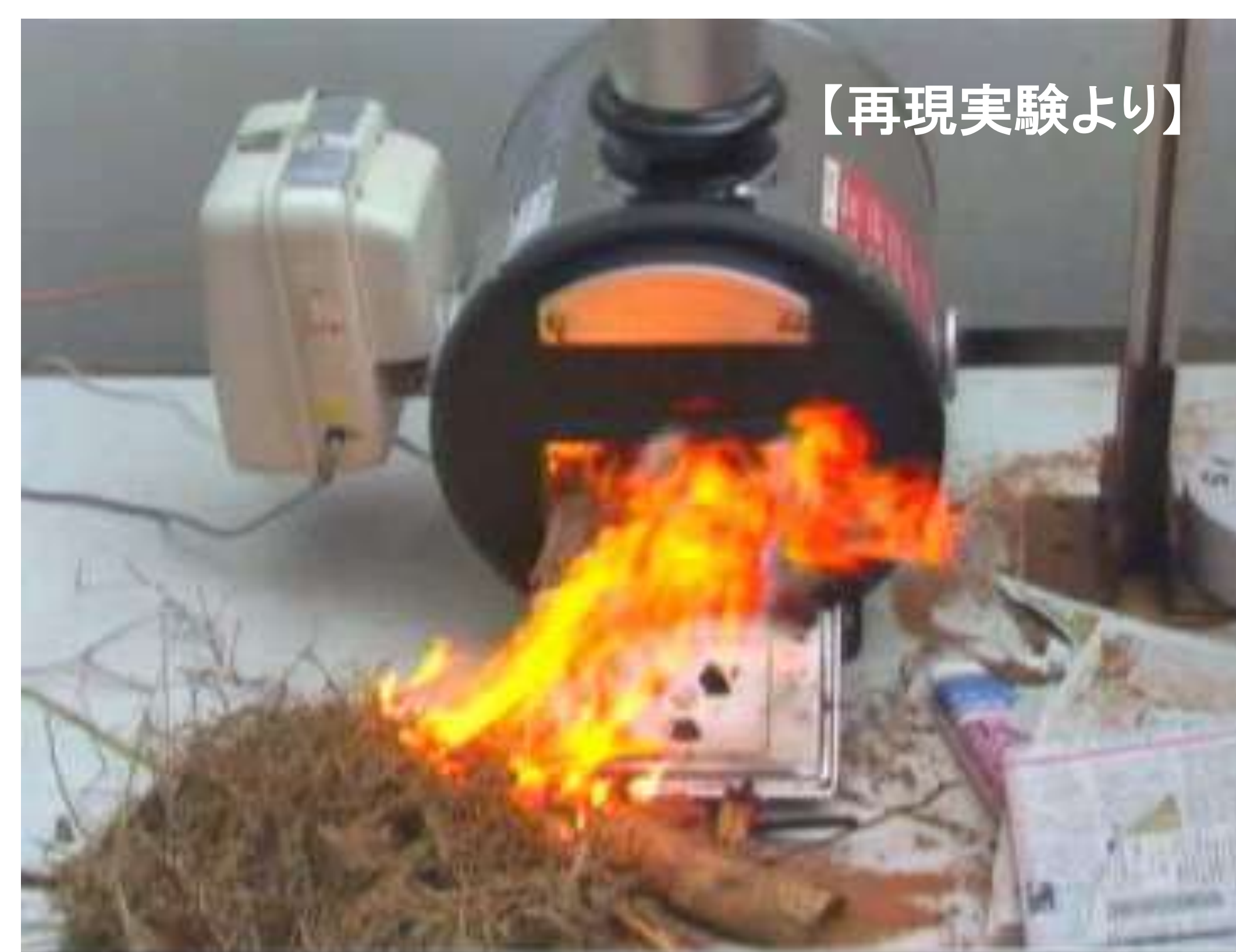
まき兼用ふろがまの近くに 枯れ葉を置いた再現実験
