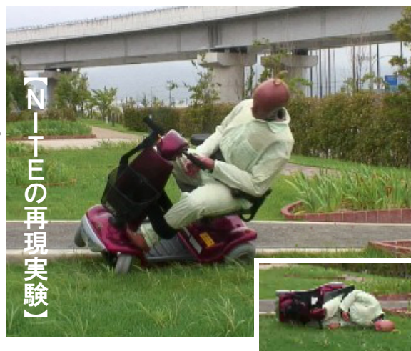
路肩から脱輪して転倒しました
