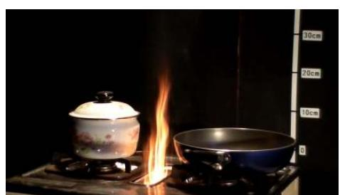
写真左：受け皿に油脂がたまつた状態で水を入れて点火。油脂に着火後約4分で火の高さは90cmを超えました。
