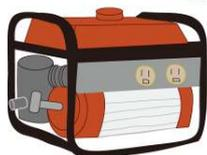
【事例③】発電機を換気をしていない室内で使用していたため、排気ガスがこもって一酸化炭素中毒に至ったものです。
