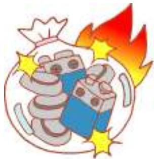
【事例②】買い置きのボタン電池の包装をはがして複数の電池と同じ袋に入れていたため、他の電池の金属外郭を通じてショートし、内圧が上がって破裂したものです。
